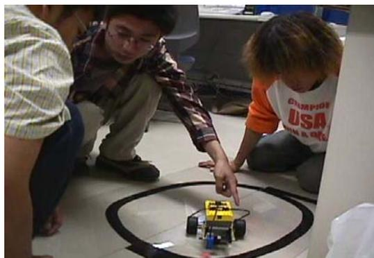
図 4 光センサーによる走行領域制御
