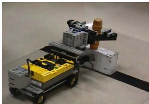
図 5 タッチセンサーによる work の運搬
