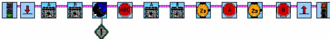
は光センサーが黒枠を感知すれば、
