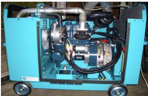
図15 実験で使用したディーゼル発電機
