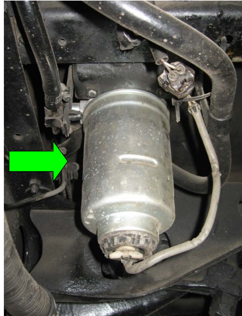
燃料フィルター（バスの底部）
