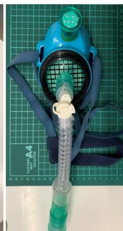
図 1. 電動エアークポンプ型陽圧換気式感染防御密閉マスクの構造
