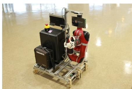
図2：全自動収穫ロボットの外観
