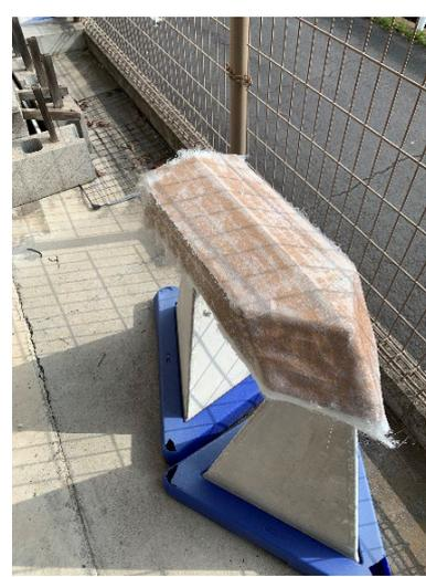
図4 FRPを用いた模型
