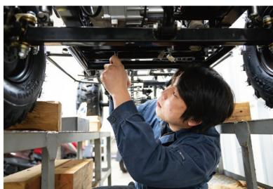
ミニジープの様々な箇所の点検等を終えた後、車体の下に潜り込んでの作業にあたる。50CCエンジンを固定するため、ボルトをトルクレンチで締める作業を行う。
