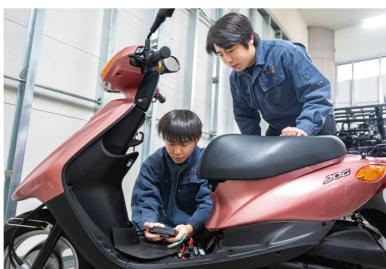
50CCエンジンを搭載した原動機付自転車を、「自己診断装置」で点検する。ライト、スロットル角度、冷却水の温度などを調整するほか、CO濃度の変更などを行う。
