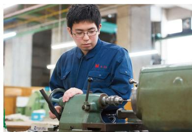
ロボット機体製作のための、部品加工の作業にあたる。あらかじめ作成してある製図をもとに、切り出した棒状のパーツの中心部に旋盤機で穴を開ける。
