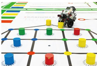
2022年大会のコースで、ロボットの動きを再現。レースコースを走った後にゲームエリアへロボットが侵入し、赤・青・黄・緑4色のブロックを所定の場所へ運ぶ。
