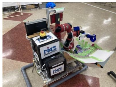
図2：全自動収穫ロボットの外観
