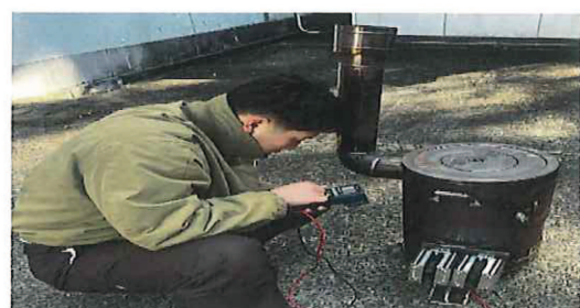
図4. 薪ストーブを用いた発電実験風景
