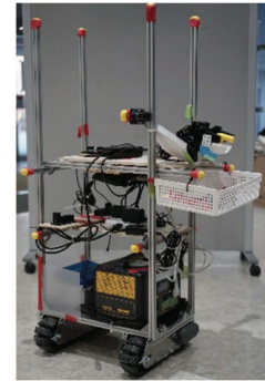
図1：人工知能でトマトを認識 図2：収穫ロボット(レール) 図3：収穫ロボット(フリー)
