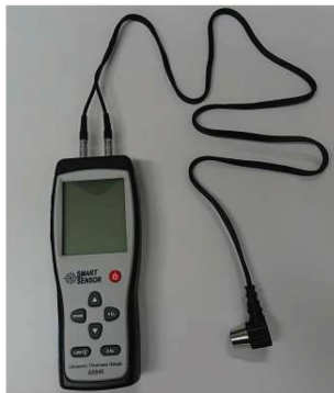
図 1 超音波の板厚計測装置
