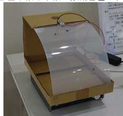
図 4 試作した曲げ板スピーカ
