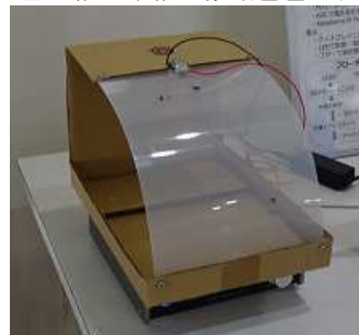
図 4 試作した曲げ板スピーカ
