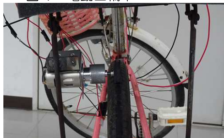
図 3 アシスト機構と回生充電装置の一部
