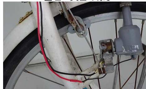
図 3 アシスト機構と回生充電装置の一部
