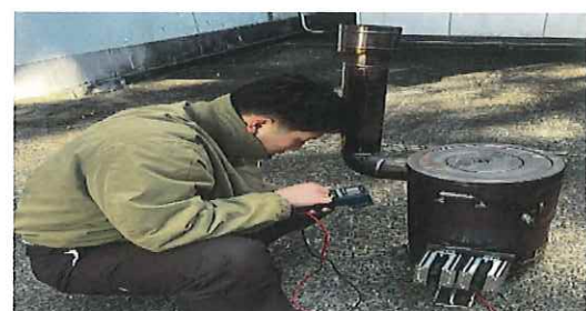
図4. 薪ストーブを用いた発電実験風景
