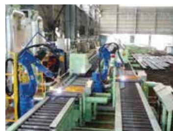
自動鋼材溶断ロボット開発テスト
